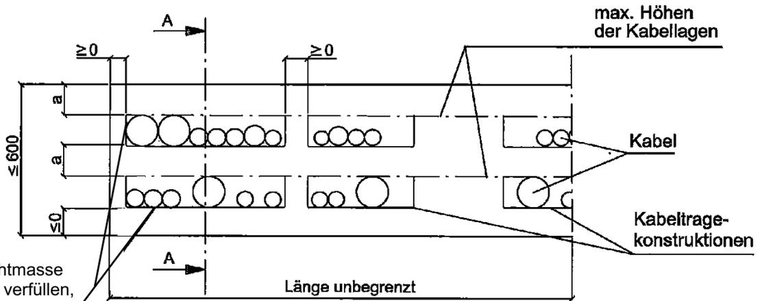
Fugen mit Brandschutzdichtmasse "Hilti CP 611 A" verfüllen, sofern die Kabeltragekonstruktion an der Bauteillaibung anliegt (s. Abschnitt 2.5.2.2)
