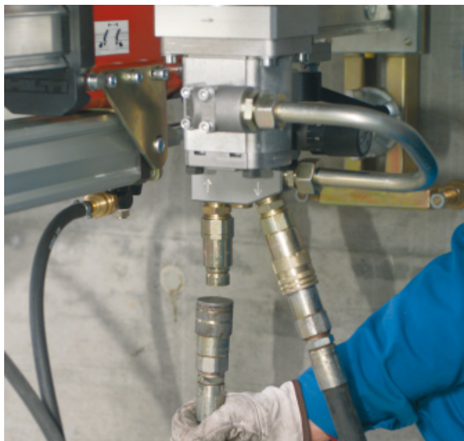
油圧ホースを駆動ユニットに接続します (DS WS10)。
