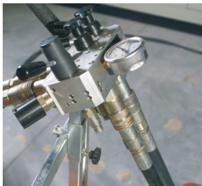
油圧ホースをバルブブロック／油圧ユニットに接続します (D-LP15 / D-RC22 / D-LP32)。
