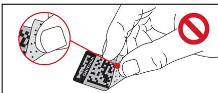
Не касайтесь и не допускайте загрязнения клейкой поверхности Smart Label, когда вы снимаете ее с рулона.
