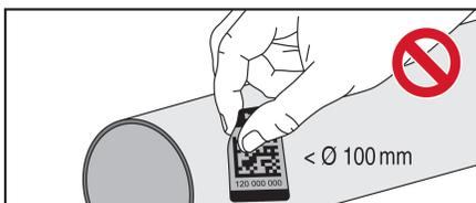
Не размещайте Smart Label на поверхностях диаметром меньше 100 мм (3,94").
