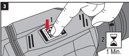
Прижмите Smart Label ладонью или роликом (усилие прижима должно быть равномерным). Чем сильнее будет прижим, тем прочнее будет держаться Smart Label.
