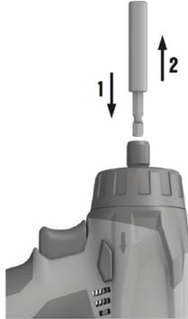
1. Mettre l'inverseur du sens de rotation droite / gauche sur la position médiane ou sortir l'accu de l'appareil.
